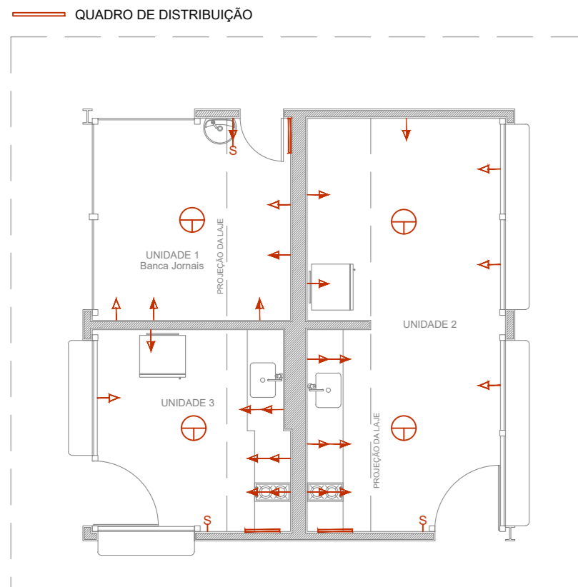
PONTOS ELÉTRICA ESCALA 1/75
